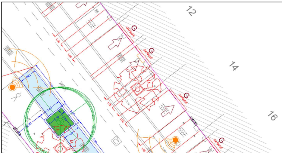
Figure 6 Zone libre d'1m de part et d'autre des garages - Impossibilité de placer une place de stationnement ou une fosse convenable du n°10 au 14.
